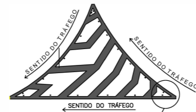
DETALHE 14 S/ESCALA ILHA - COR BRANCA EXTRUDADO
