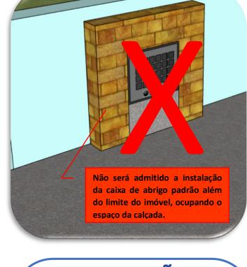
Em terrenos que não possuem muros, pode ser utilizado o bloco com os tubos camisa. Não será permitido apenas o bloco solto, eles devem estar concretados ou fixados de alguma outra
